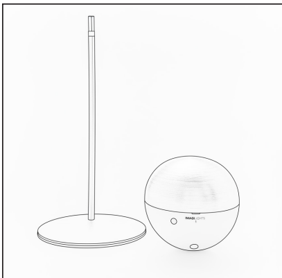
Zusammenbau der Tischleuchte: Metallplatte, Stange und LED-Modul
