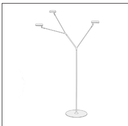
Composición de la lámpara de árbol: placa metálica, 3 postes con extensiones, 3 módulos led
